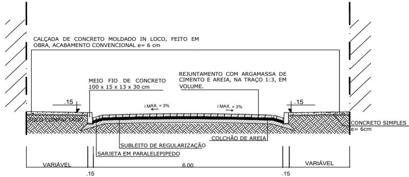
\*CASO O NÍVEL DA CALÇADA SEJA DIFERENTE 15CM A RAMP A DEVERÁ SE ADAPTAR A NOVA ALTURA.
