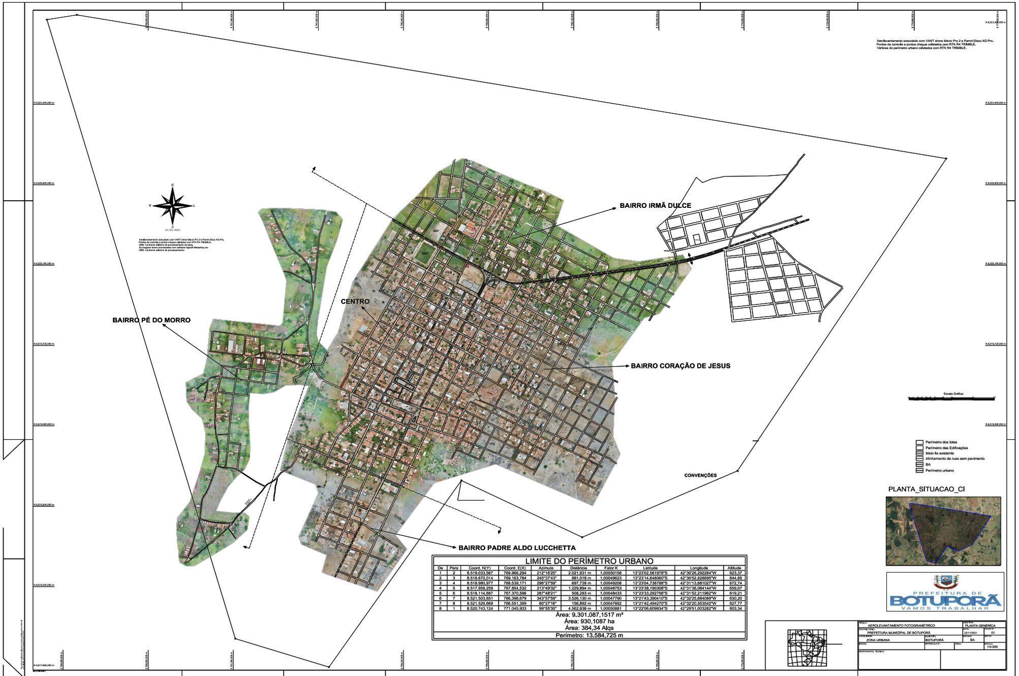
Aerolevanteamento executado com VANT drone Meris Pro 2 e Parrot Disco AG Pro. Pontos de controle e pontos visuais obtidos com RTK na TRIMBLE. Verticais do pavimento obtidos com RTK na TRIMBLE.
