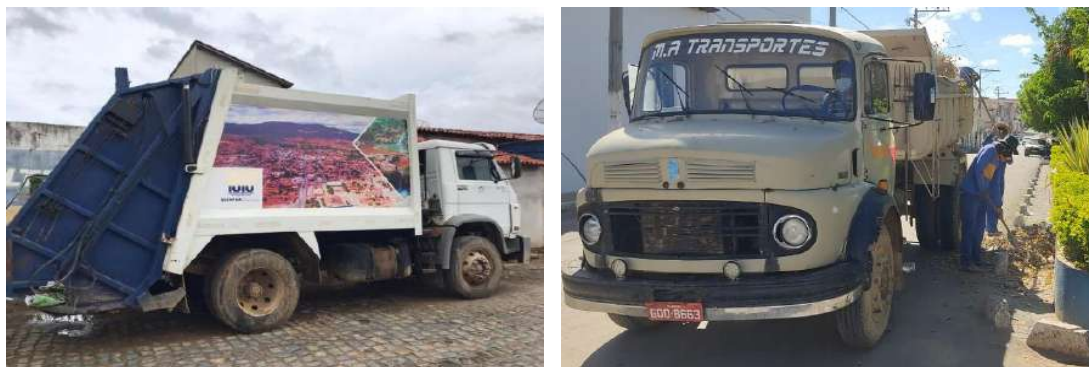
Figura 110 – Caminhão compactador e caminhão basculante utilizados na coleta convencional dos resíduos sólidos domiciliares
