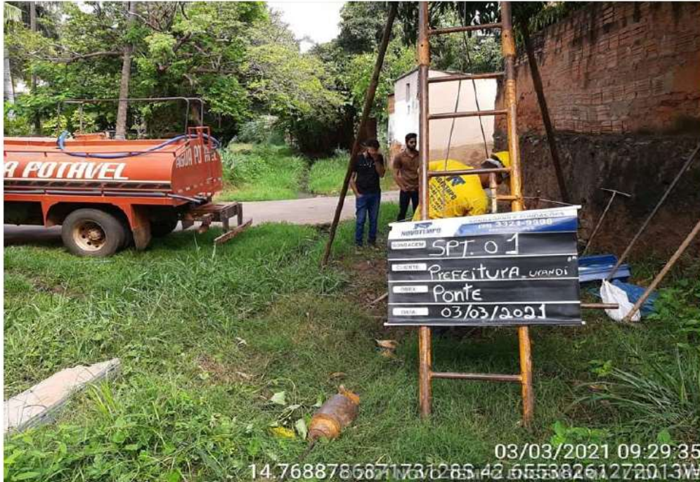
EXECUÇÃO SONDAAGEM À PERCUSSÃO SP 01 - URANDI/BA
