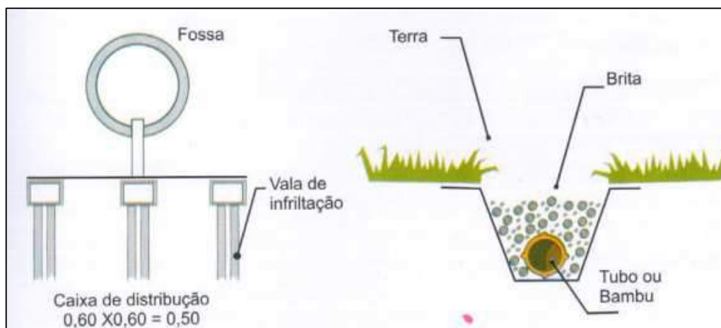
Figura 6.94 – Sistema de tratamento individual - Vala de infiltração.
